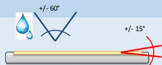
Geschützt gegen Staub in schädigender Menge und Schutz gegen fallendes Sprühwasser bis  $60^\circ$  gegen die Senkrechte.
