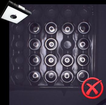
Hier ist die **Flächenleuchte gleich groß wie die Messfläche**. Der ausgeleuchtete Bereich ist deutlich zu klein.
